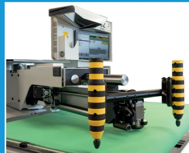
La **testa telescopica a scomparsa** crea le condizioni ottimali di integrazione uomo-macchina, agevolando la visibilità del materiale e del **proiettore laser integrato**, sempre nitido su ogni tipo e colore di materiale e in ogni condizione di illuminazione.
